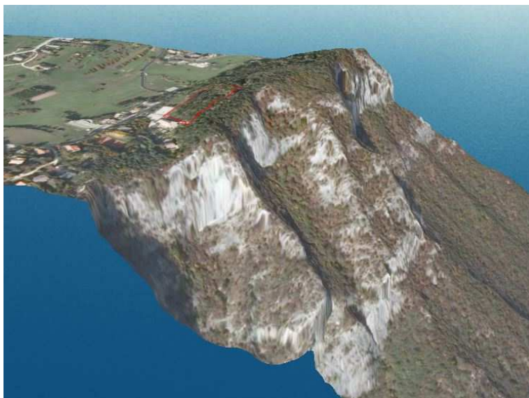
Fig. 2: vista DTM 3D da Sud del bordo orientale del ripiano di Fai, nei pressi della zona in esame (segnata in rosso). Si osserva come essa si ponga ad distanza di sicurezza ( \geq 30 m) dalla sommità della parete rocciosa.
